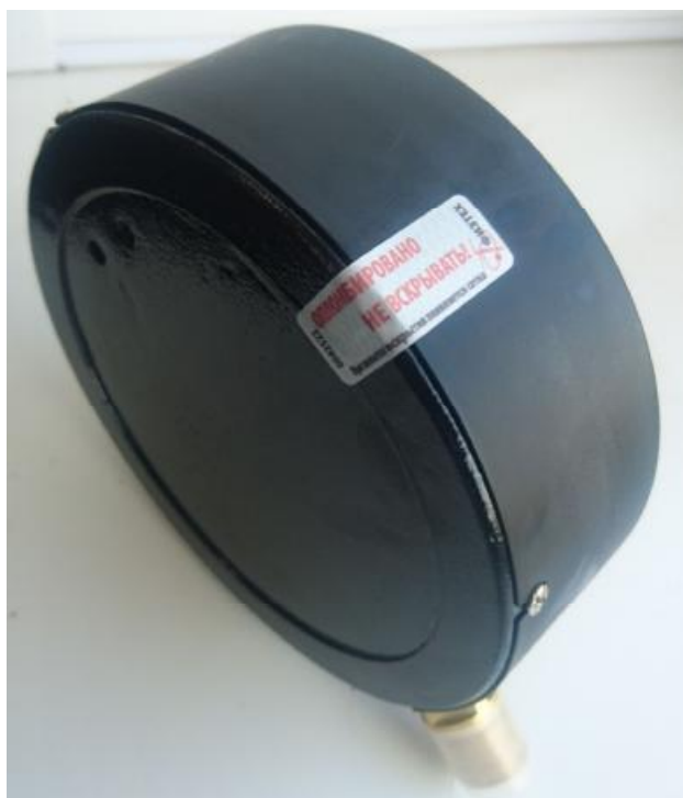
Рисунок 7 – Заводская пломбировка с помощью наклейки
